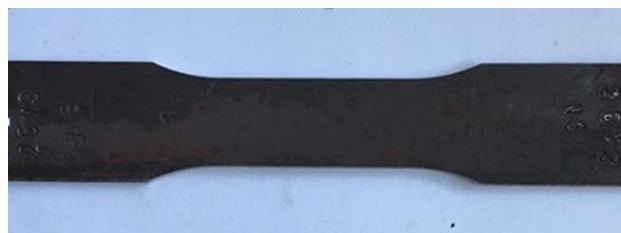
Slika 16. Uzorak pravokutnog poprečnog presjeka obrađen CNC strojem
