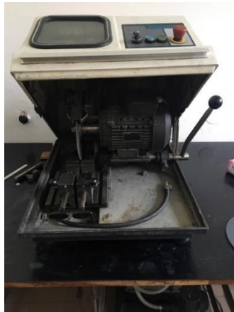
Slika 24. Uređaj Buehler ABRASIMET 2 za rezanje uzoraka kod metalografske pripreme
