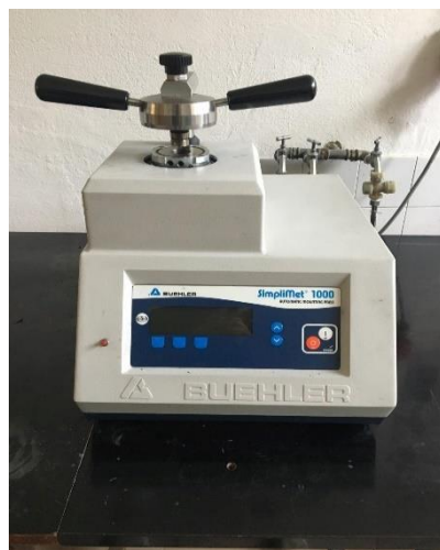
Slika 25. Uređaj SimpliMet 1000 za ulaganje uzoraka toplim prešanjem
