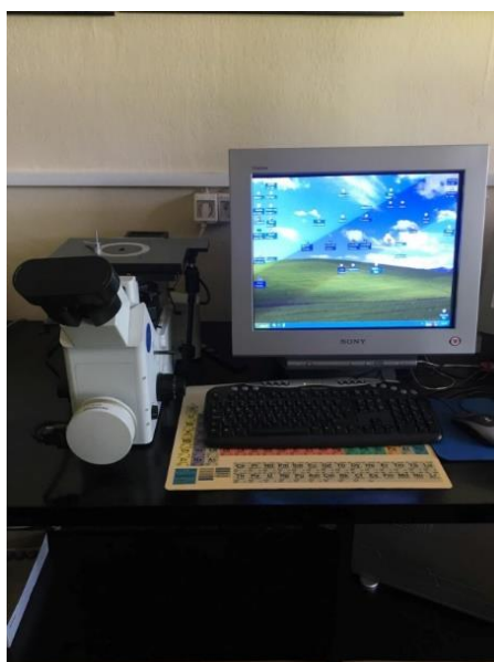
Slika 27. Optički mikroskop Olympus GX 71 s digitalnom kamerom DP70
