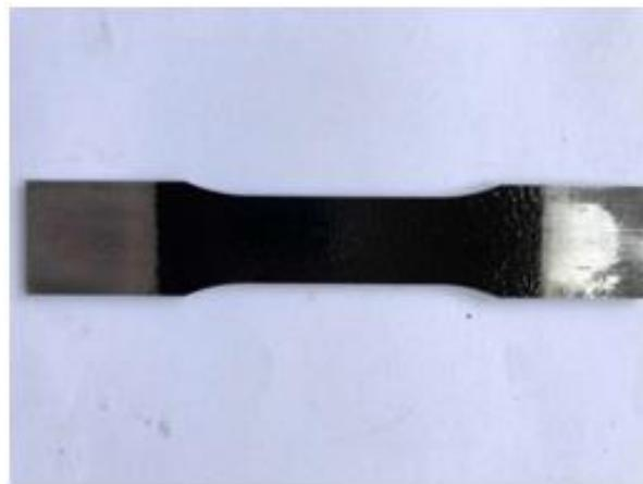
Slika 17. Uzorak nakon nanošenja premaza
