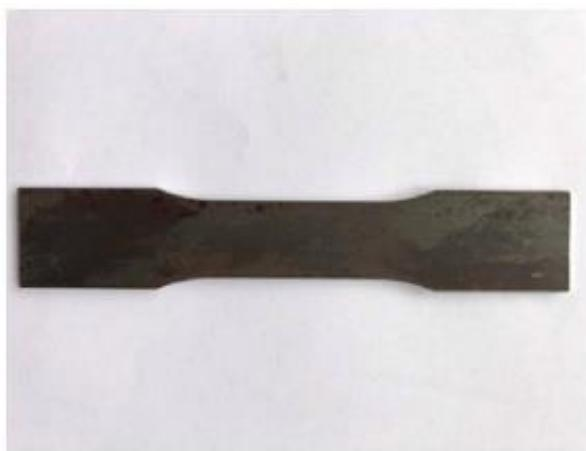
Slika 13. Uzorak za statičko vlačno ispitivanje prije brušenja
