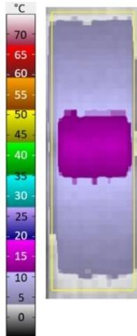
Slika 24. Maksimalna promjena temperature na ispitnom dijelu uzorka
