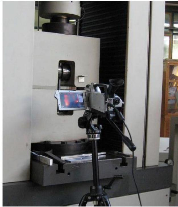
Slika 9. Ispitivanje metodom termografije [18]
