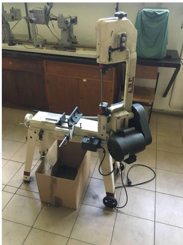
Slika 11. Rezalica JET HVBS56M-085E
