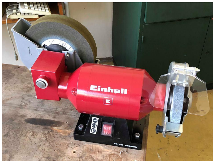
Slika 14. Brusilica Einhell TC-WD 150/200
