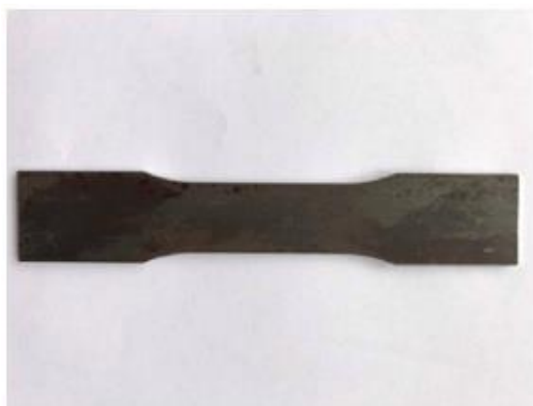
Slika 13. Uzorak za statičko vlačno ispitivanje prije brušenja
