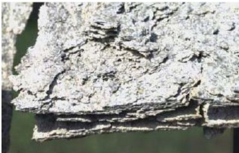
Slika 13. Primjer eksfolijacije kod Al-legure u morskoj atmosferi [13]
