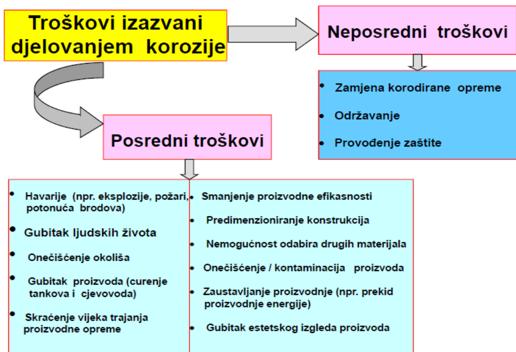
Slika 1. Podjela vrste troškova nastalih djelovanjem korozije [4]
