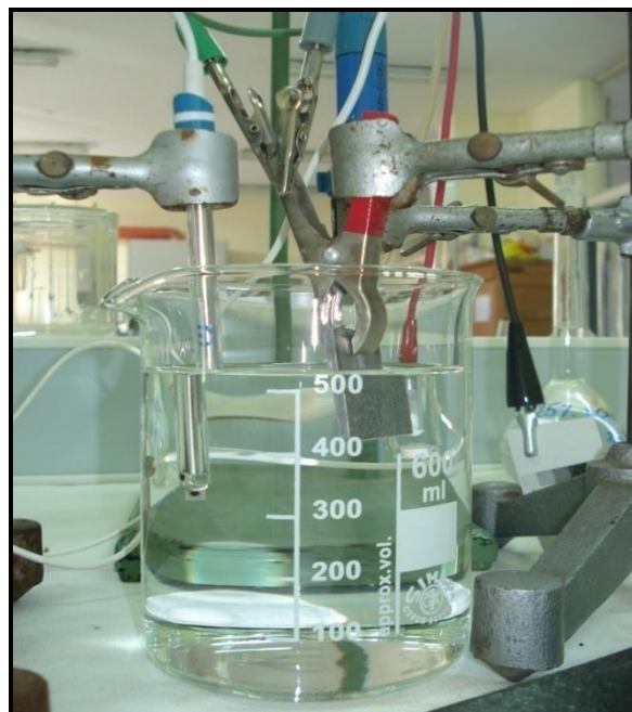
Slika 26. Troelektrodna ćelija za provođenje elektrokemijskih mjerenja
