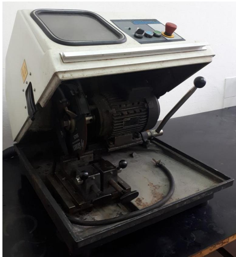
Slika 31. Fotografija uređaja za rezanje uzoraka „Buehler Isomet“
