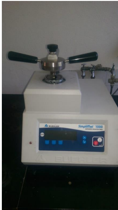
Slika 24. Uređaj za ulaganje uzoraka vrućim prešanjem SimpliMet® 1000
