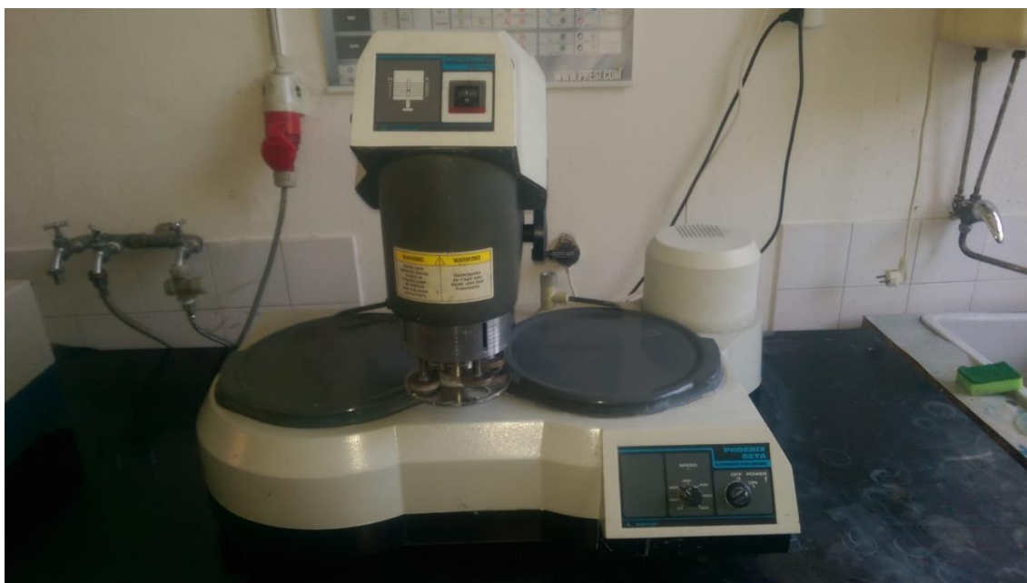
Slika 25. Uređaj za brušenje i poliranje Buehler
