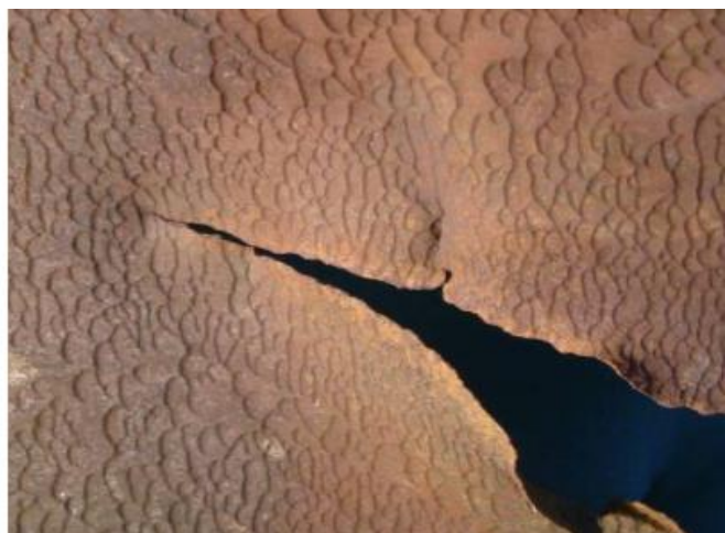
Slika 7. Posljedica erozijsko korozivnog oštećenja cjevovoda za transport nafte [14]
