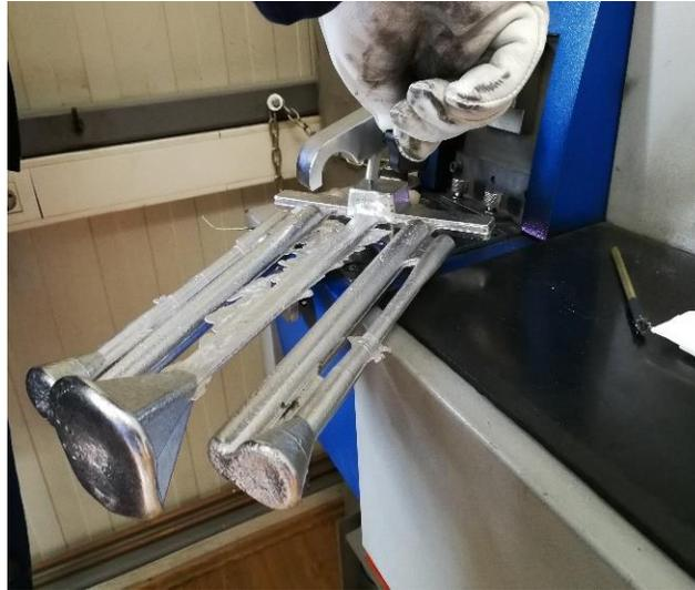
*Slika 46. Odljevak iz ASTM kalupa*
