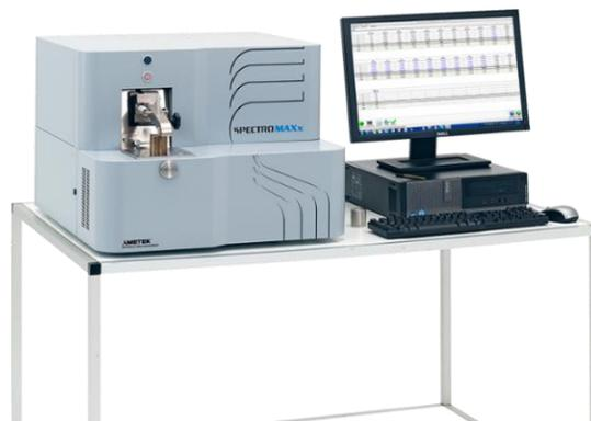
*Slika 47. Spektrometar SPECTROMAXx*
