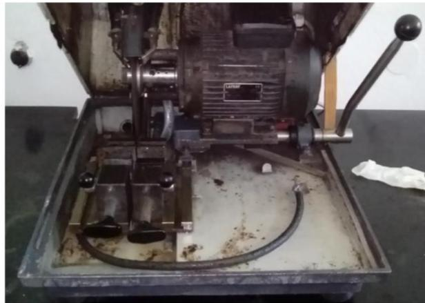
*Slika 52. Rezalica Buehler za izradu uzoraka*
