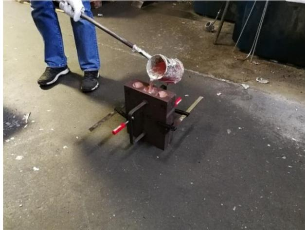
*Slika 44. Lijevanje taline u ASTM kokilu*
