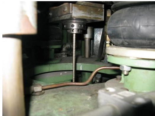
Slika 28. Fotografija izvlačenja šipke legure pri kontinuiranom lijevanju
