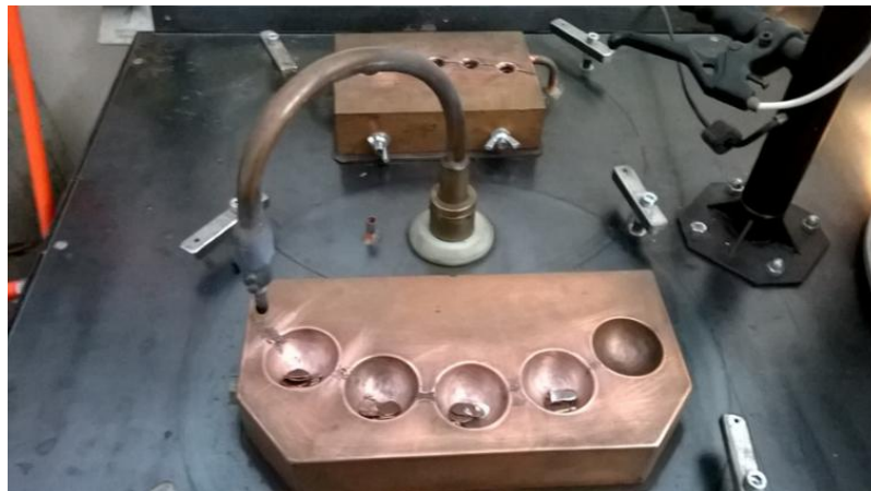
Slika 23. Odvagani čisti metali u bakrenom kalupu i grafitna elektroda
