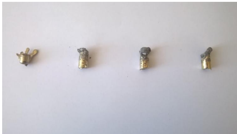
Slika 26. Izliveni uzorak Cu-(8-9)% mas. Al-(9-10)% mas. Mn legure
