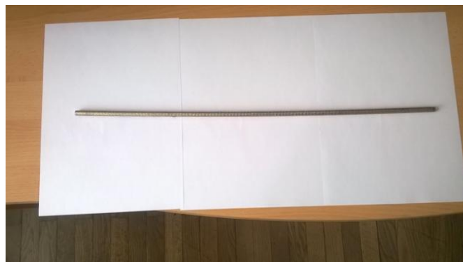
Slika 29. Dobivena šipka Cu-Al-Mn legure
