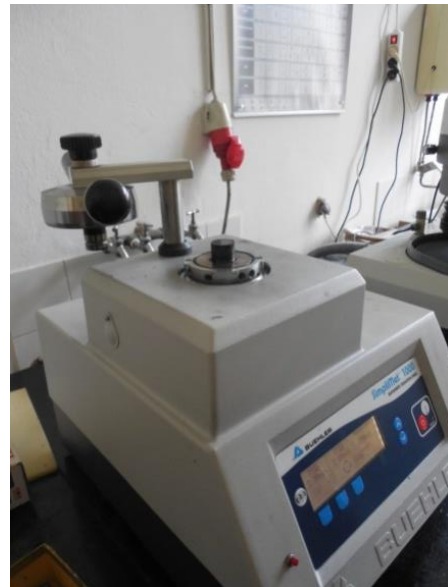
Slika 18. Uređaj za vruće izostatsko prešanje: a) masa i uzorak u fazi zagrijavanja, b) uzorak zaliven u masu
