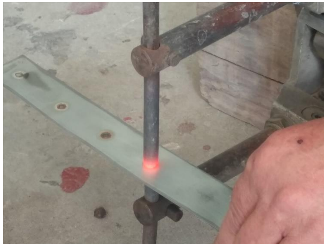
Slika 15. Elektrootporno točkasto zavarivanje izrezanih limova punkt aparat/klještima
