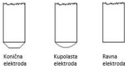
Slika 8. Najčešći oblici vrhova elektroda [15]
