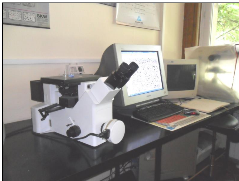
Slika 3.8. Metalografski mikroskop OLYMPUS GX 51 s digitalnom kamerom i računalo na kojem se nalazi programskim paketom AnalySIS ® Materials Research Lab za određivanje mikrostrukturnih značajki analiziranih uzoraka
