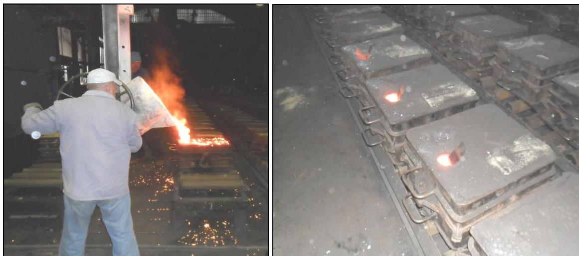
Slika 3.3. Lijevanje stepenastih odljevaka
