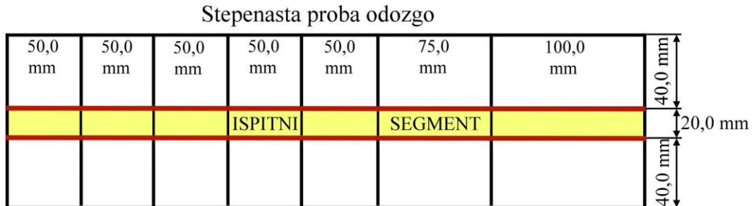
Slika 3.4. Shematski prikaz izrezivanja segmenta po duljini stepenastih odljevaka
