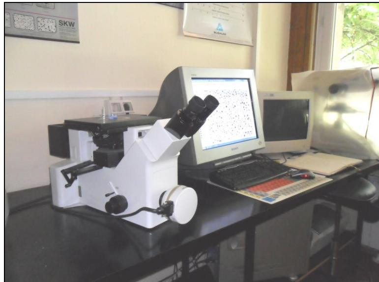
Slika 3.8. Metalografski mikroskop OLYMPUS GX 51 s digitalnom kamerom i računalom na kojem se nalazi programskim paketom AnalySIS® Materials Research Lab za određivanje mikrostrukturnih značajki analiziranih uzorka
