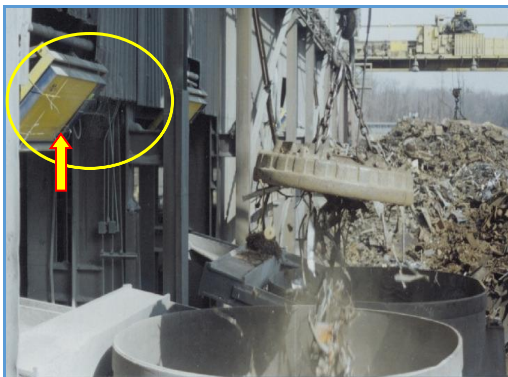
Slika 11. Dodatna kontrola a) pri transportu čeličnog otpada i b) pri utovaru čeličnog otpada u „košaru“ [40]
