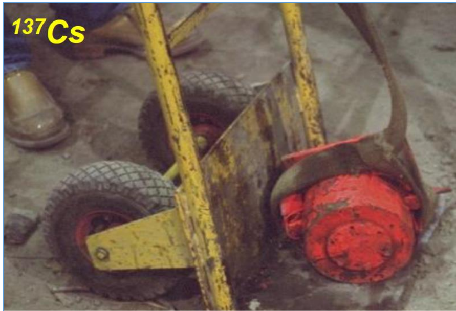
Slika 3. Dio medicinske opreme zagađen ^{137}\text{Cs} pronađen u čeličnom otpadu [17]
