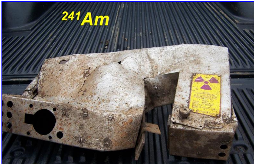
Slika 1. Dio medicinske opreme zagađen ^{241}\text{Am} pronađen u čeličnom otpadu [17]
