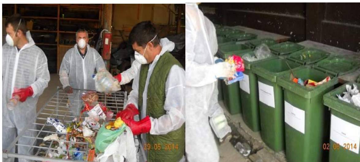
Slika 3. Analiza sastava komponenti komunalnog otpada
