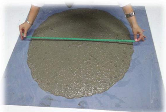
Slika 2. Ispitivanje rasprostiranja slijeganjem
