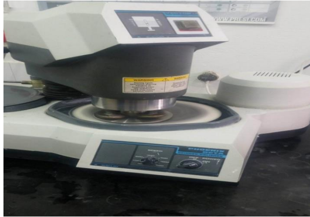
Slika 23. Fotografija uređaja Buehler “Phoenix Beta“ za metalografsku pripremu uzoraka
