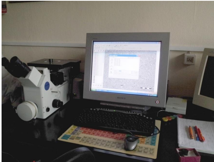
Slika 34. Fotografija optičkog mikroskopa Olympus GX 51 s digitalnom kamerom Olympus DP70
