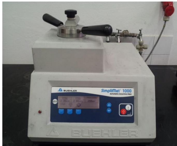
Slika 31. Fotografija uređaja Simplimet ® 1000 proizvođača Buehler
