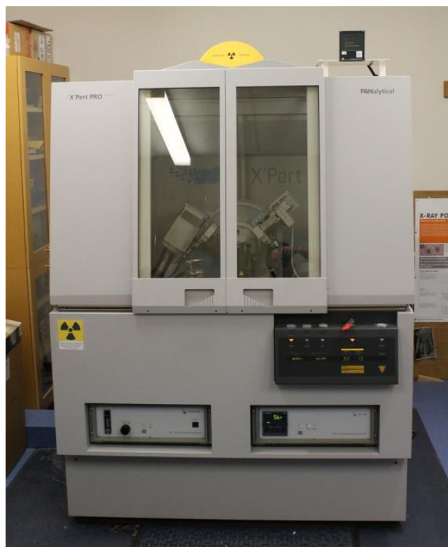
Slika 18. Rendgenski difraktometar PANalytical, X'Pert PRO
