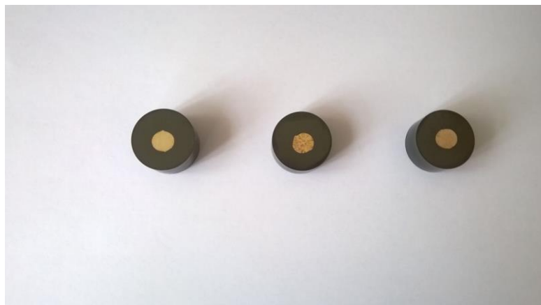
Slika 14. Uzorci zaliveni u plastičnu masu te nagriženi
