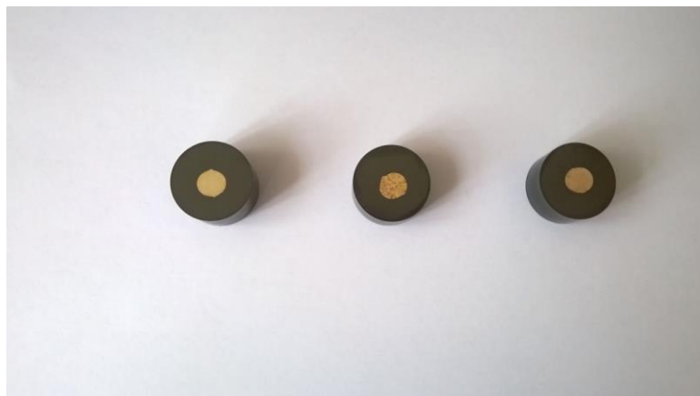
Slika 14. Uzorci zaliveni u plastičnu masu te nagriženi
