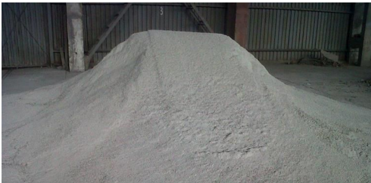
Slika 8. Prikaz bijele troske iz procesa proizvodnje u lonac - peći [16].
