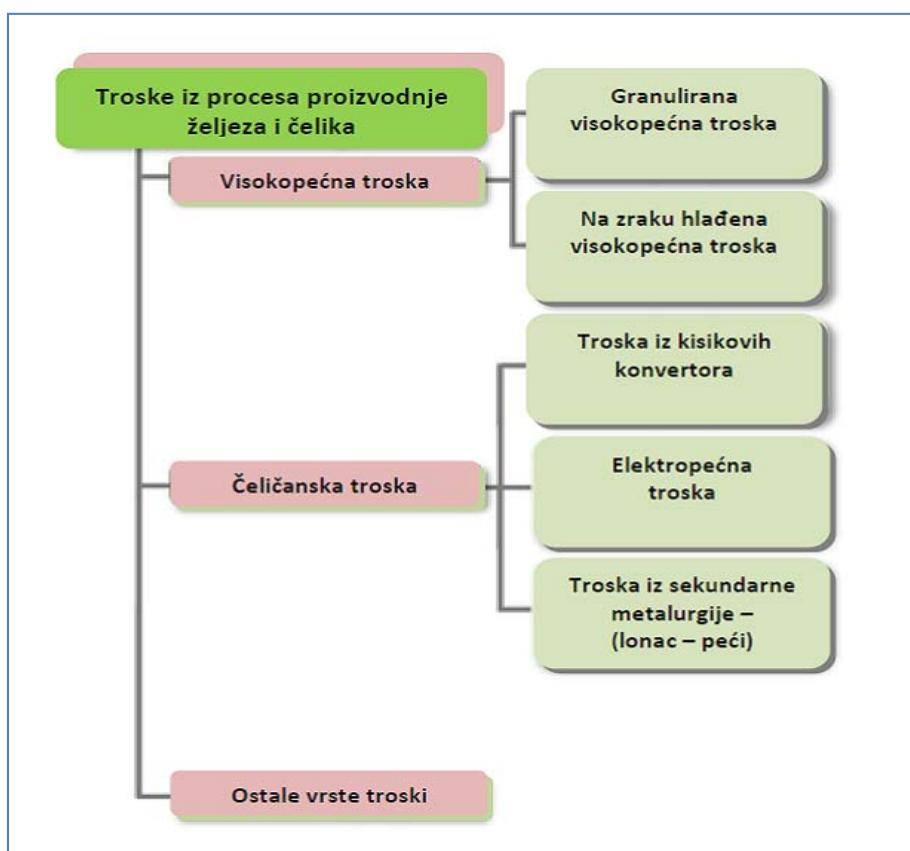
Slika 6. Troske iz procesa proizvodnje željeza i čelika [14].
