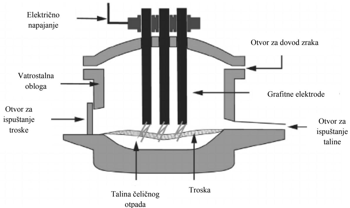
Slika 3. Prikaz poprečnog presjeka elektrolučne peći [8].
