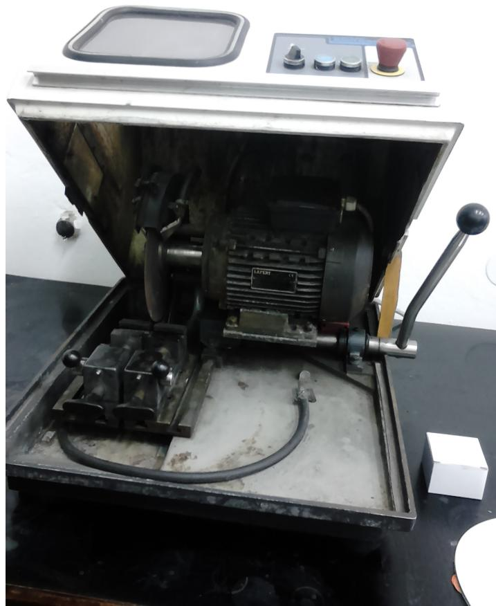
Slika 13. Fotografija uredaja za rezanje uzoraka “Buehler Isomet”.
