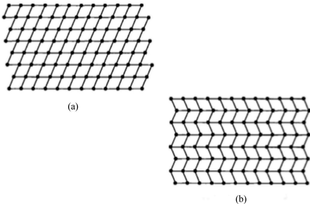
Slika 2. Prikaz dvaju mehanizama koji uzrokuju prilagodbu promjene oblika do kojih dolazi uslijed pomicanja atoma prilikom martenzitne transformacije kod: a) posmika i b) dvojnikovanja [12].
