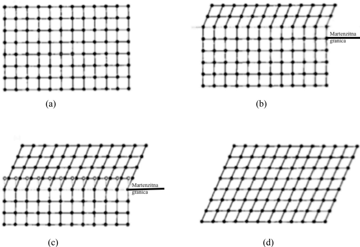
Slika 1. Shematski prikaz transformacije od austenita do martenzita gdje je a) austenitna faza, b) početak nastanka martenzita, c) rast martenzita, d) novonstala martenzitna struktrua [12].
