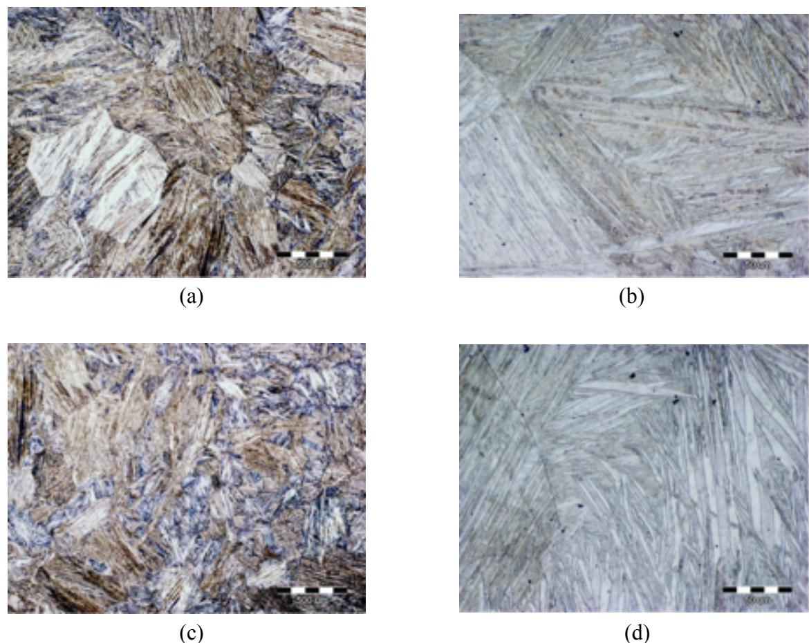
Slika 18. Optičke mikrografije Cu-Al-Mn-Ni legure s prisjetljivosti oblika u lijevanom stanju
