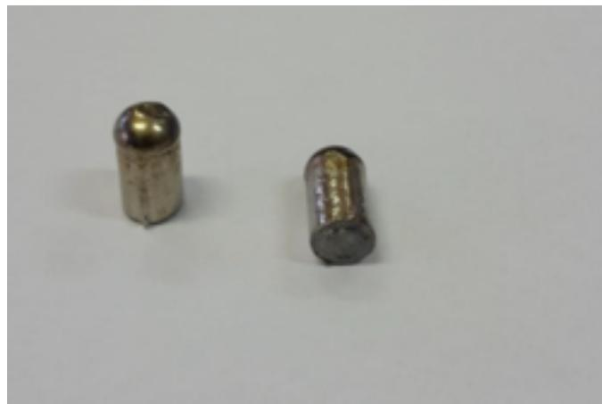
Slika 12. Fotografija ingota dobivenih lijevanjem u kalup.
