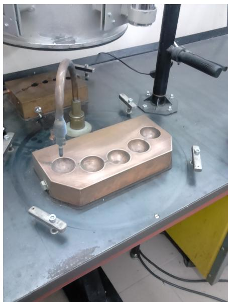
Slika 11. Fotografija peći za taljenje (bakrena anoda).
