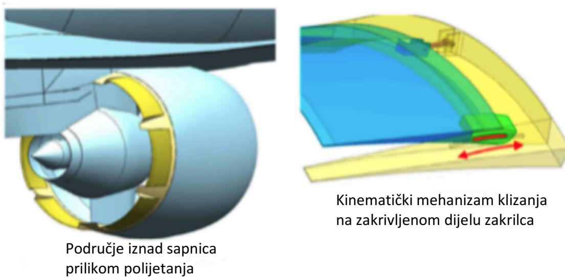
Slika 8. Velika pomična zakrilca s VAFN konceptom [15].
