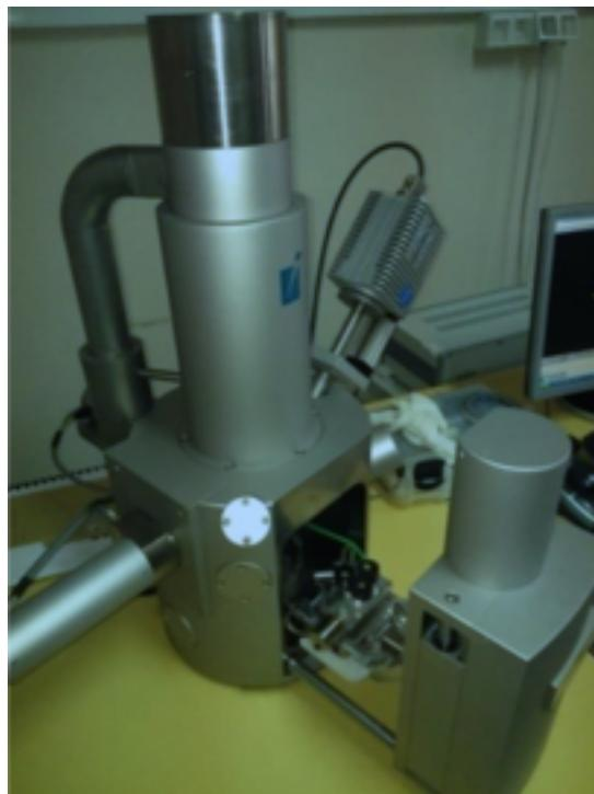
Slika 15. Fotografija pretražnog elektronskog mikroskopa
