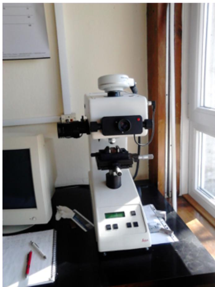
Slika 17. Fotografija uređaja za ispitivanje tvrdoće metodom “Vickers”.
