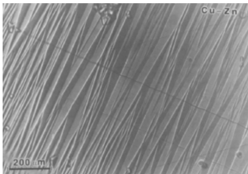
Slika 4. Optička mikrografija Cu-Zn legure s prisjetljivosti oblika [12].
