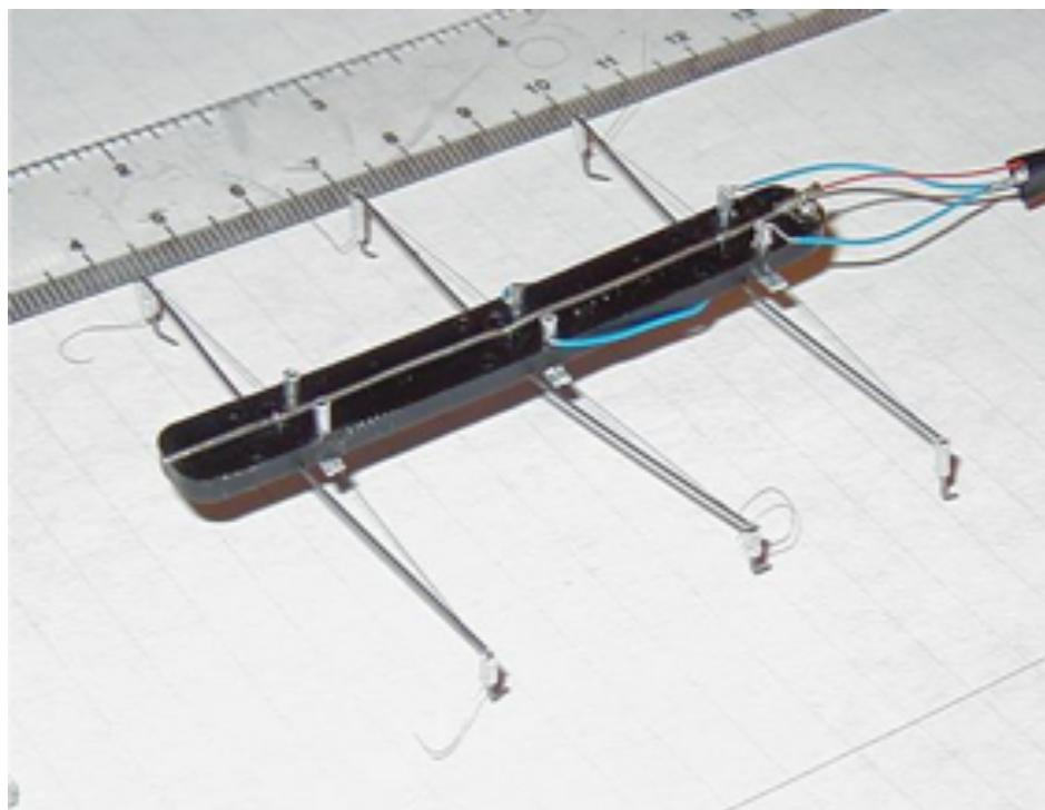
Slika 9. Stiquito robot čije su "noge" izrađene od Ni-Ti legure s prisjetljivosti oblikom [16].
