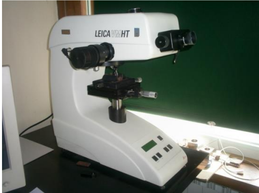
Slika 19. Fotografija tvrdomjera Leica VHMT
