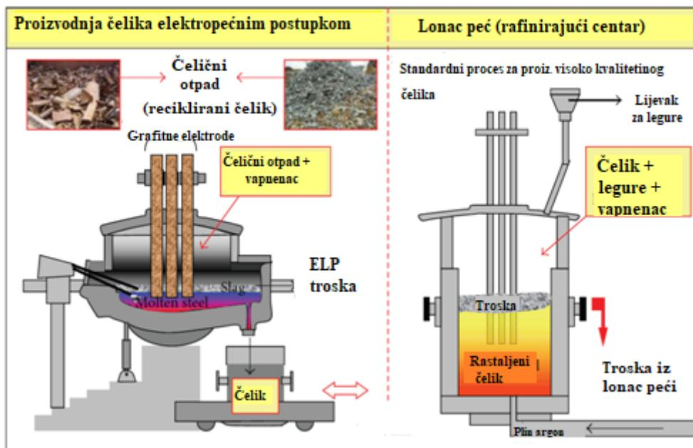
Slika 6. Shematski prikaz elektrolučne peći te lonac peći [6]
