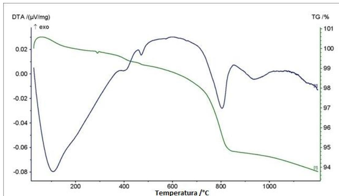
*Slika 15.* Krivulja dobivena STA analizom elektropećne troske
