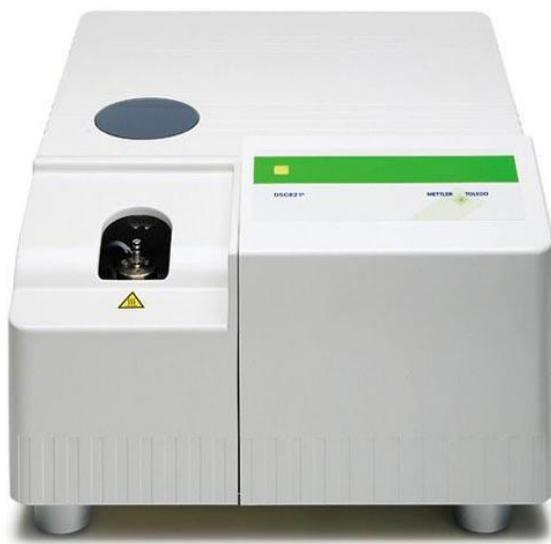
**Slika 10.** Diferencijalni pretražni kalorimetar (Mettler Toledo DSC 822e)
