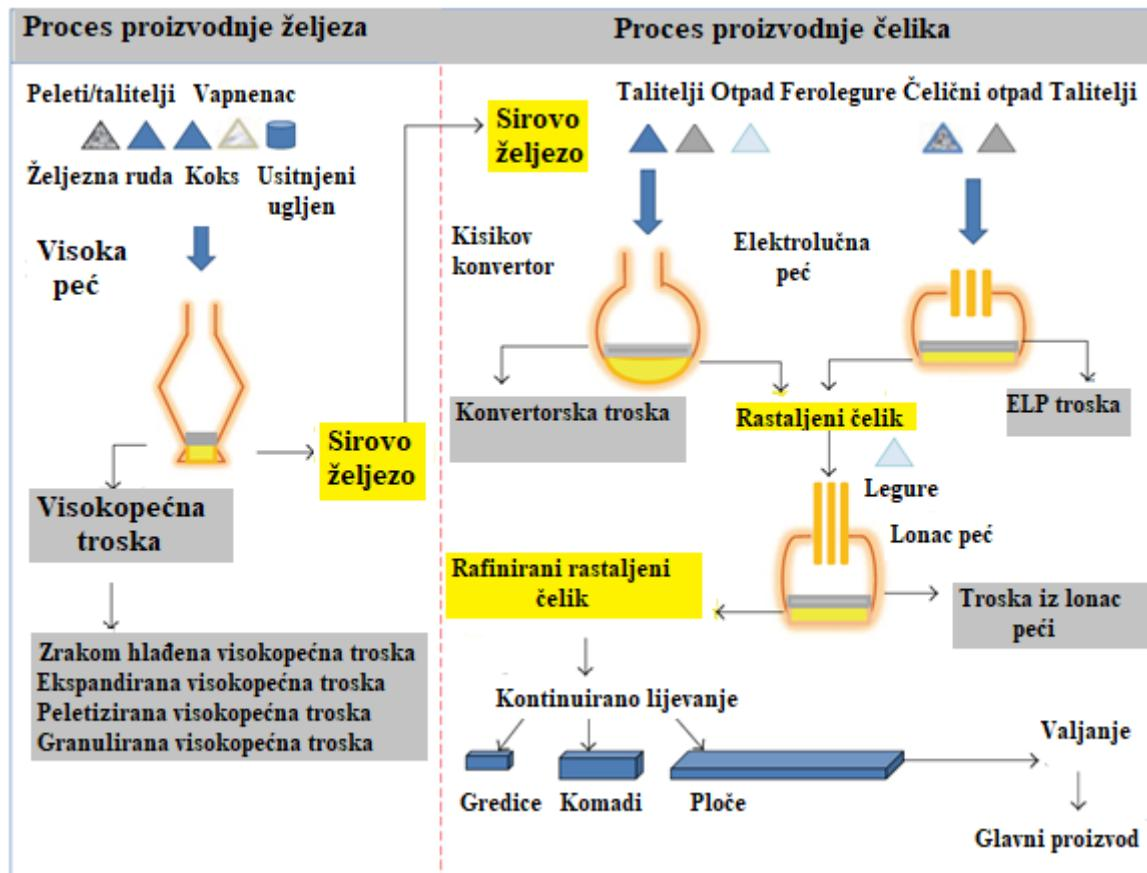
**Slika 2.** Shematski prikaz nastajanja troske u procesu proizvodnje sirovog željeza i čelika [6]
