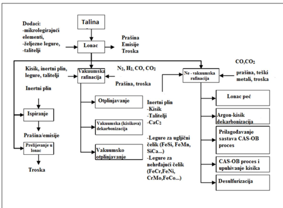
Slika 7. Mogući postupci sekundarne metalurgije za dobivanje različitih kvaliteta čelika [3]
