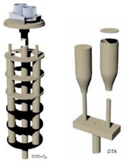
Slika 13. DSC/TG i DTA/TG nosač [13]
