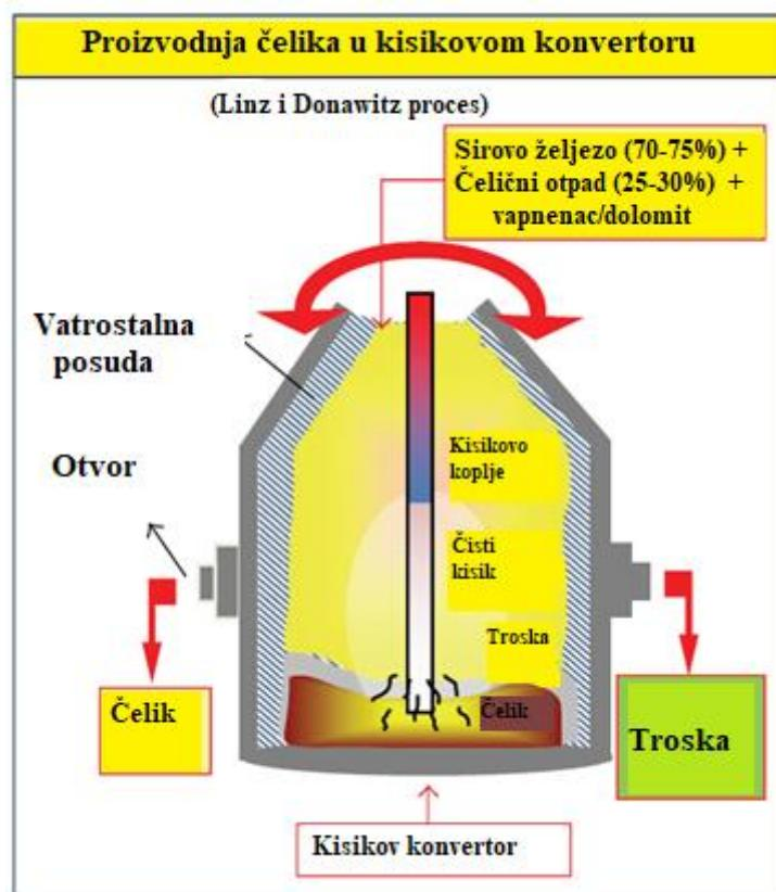
**Slika 4.** Shematski prikaz kisikovog konvertora [6]
