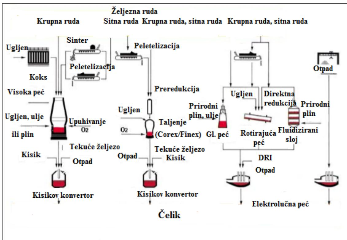
Slika 1. Postupci proizvodnje čelika u integralnim željezarama [3]
