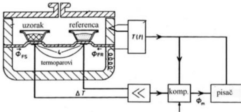
**Slika 11.** Shematski prikaz diferencijalnog pretražnog kalorimetra s toplinskim tokom [13]
