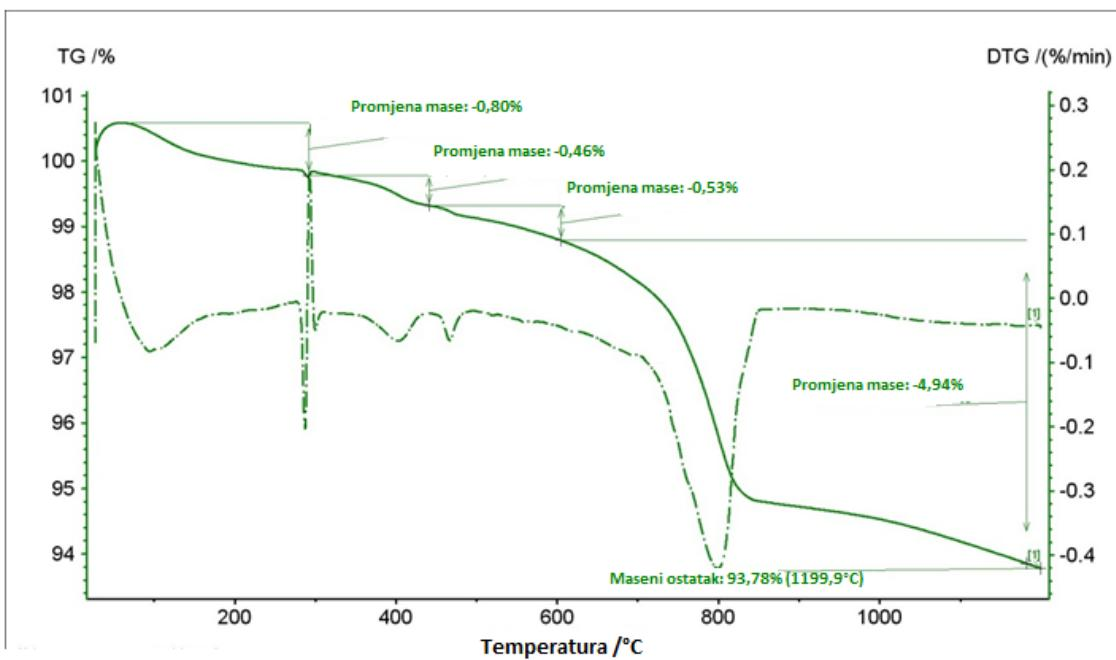
**Slika 16.** Krivulja dobivena TG/DTG analizom elektropećne troske
