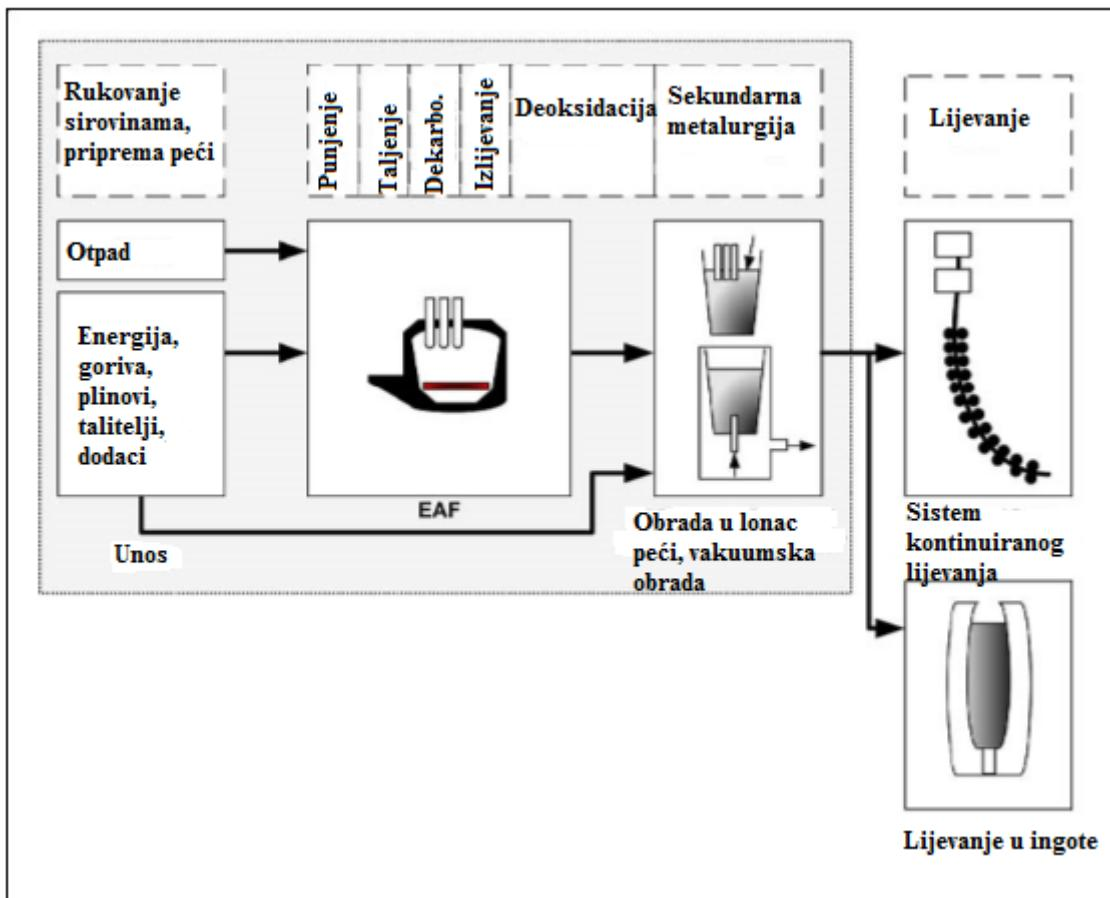
Slika 5. Proces proizvodnje čelika u elektrolučnoj peći [3]
