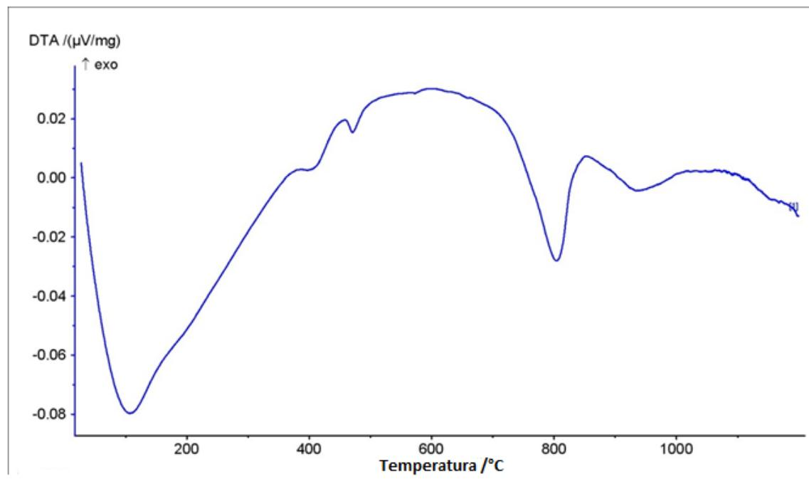
**Slika 17.** Krivulja dobivena DTA analizom elektropećne troske
