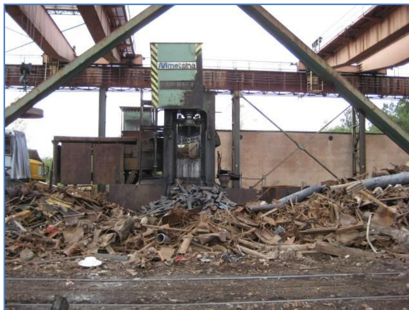
Slika 7. Uređaj za sječu i usitnjavanje čeličnog otpada [22]
