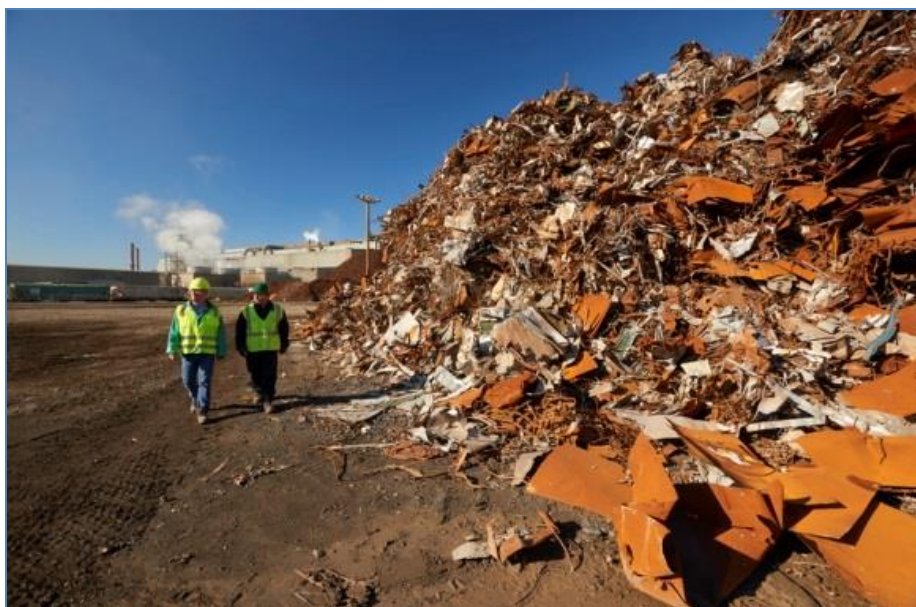
Slika 4. Skladištenje čeličnog otpada na nezaštićenoj zemljanoj površini [20]
