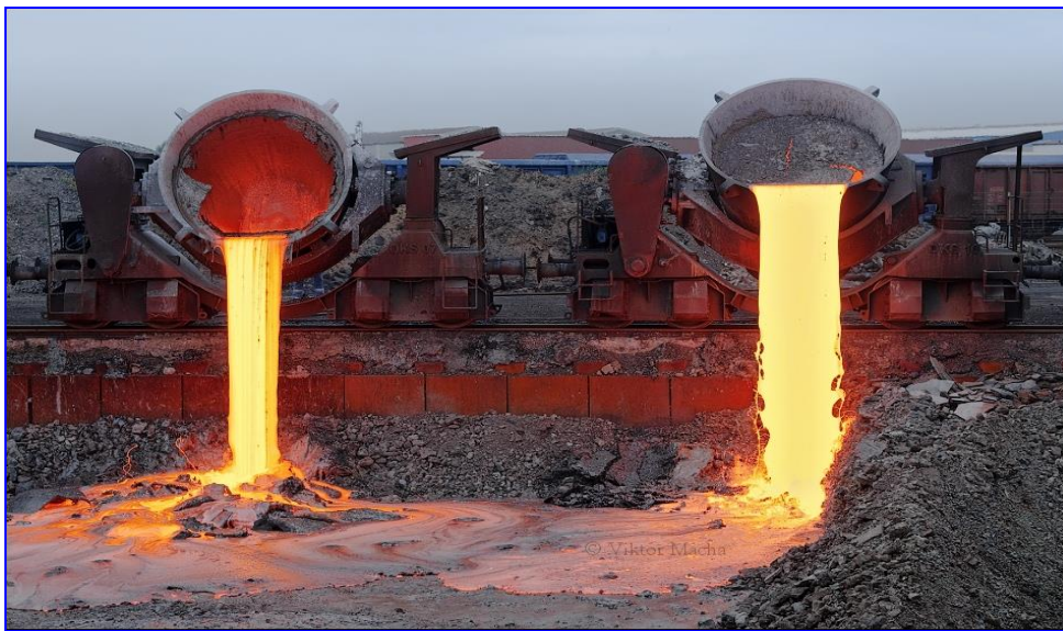
Slika 8. Izlijevanje troske na mjesto za hlađenje [16]
