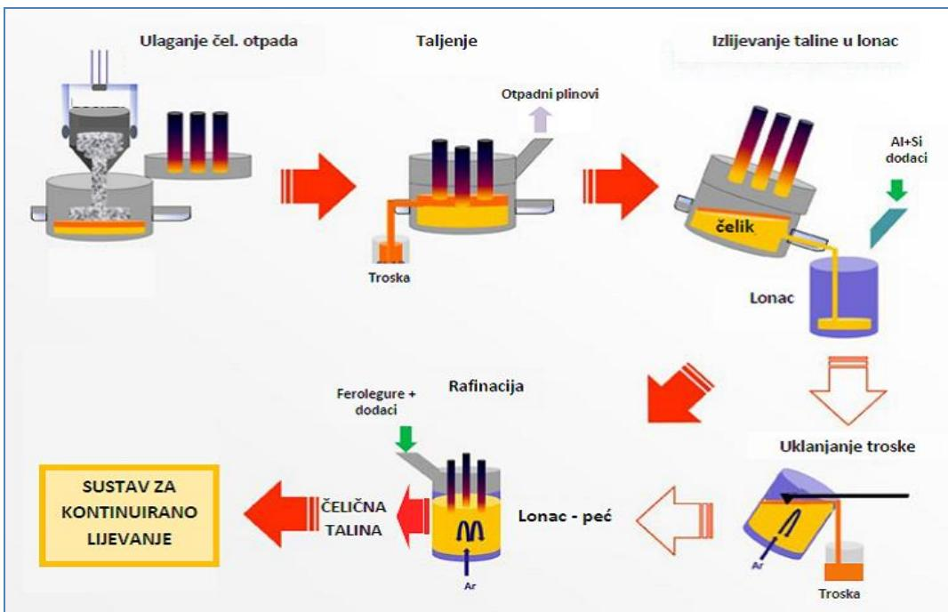
Slika 1. Prikaz faza u proizvodnji čelika elektropećnim postupkom u kombinaciji sa lonac-peći [6]
