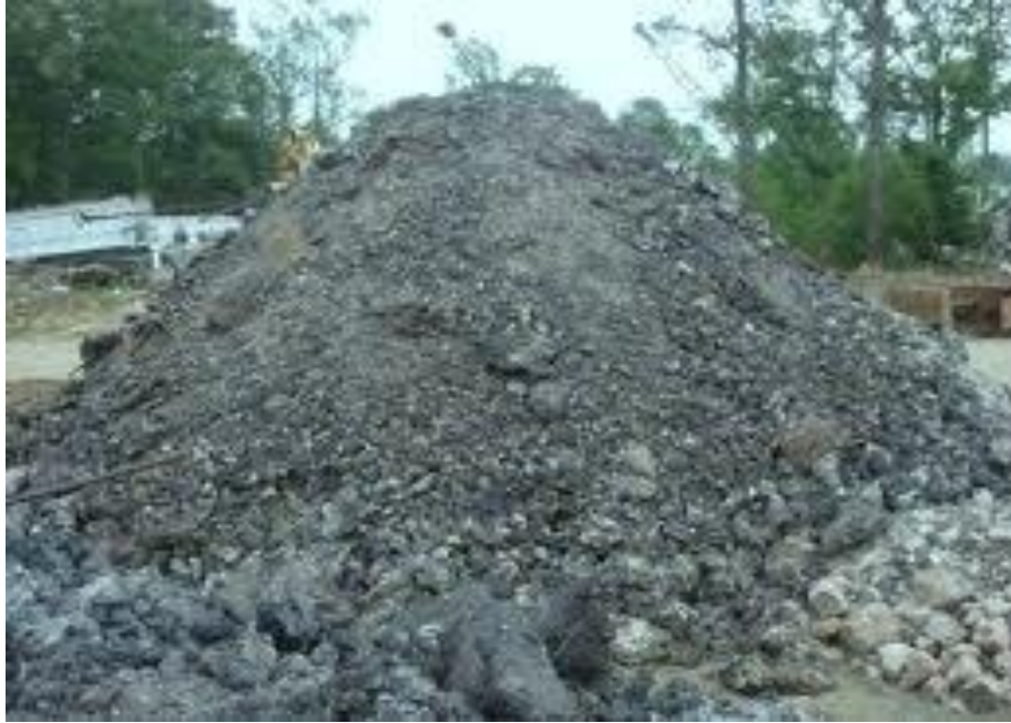
Slika 6. Crna troska iz procesa proizvodnje ugljičnih čelika elektrolučnim postupkom [14]
