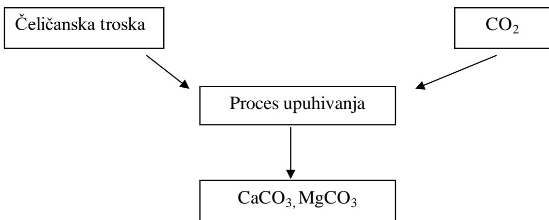
Slika 12. Osnovni princip sekvestracije CO<sub>2</sub> pomoću čeličanske troske [39].
