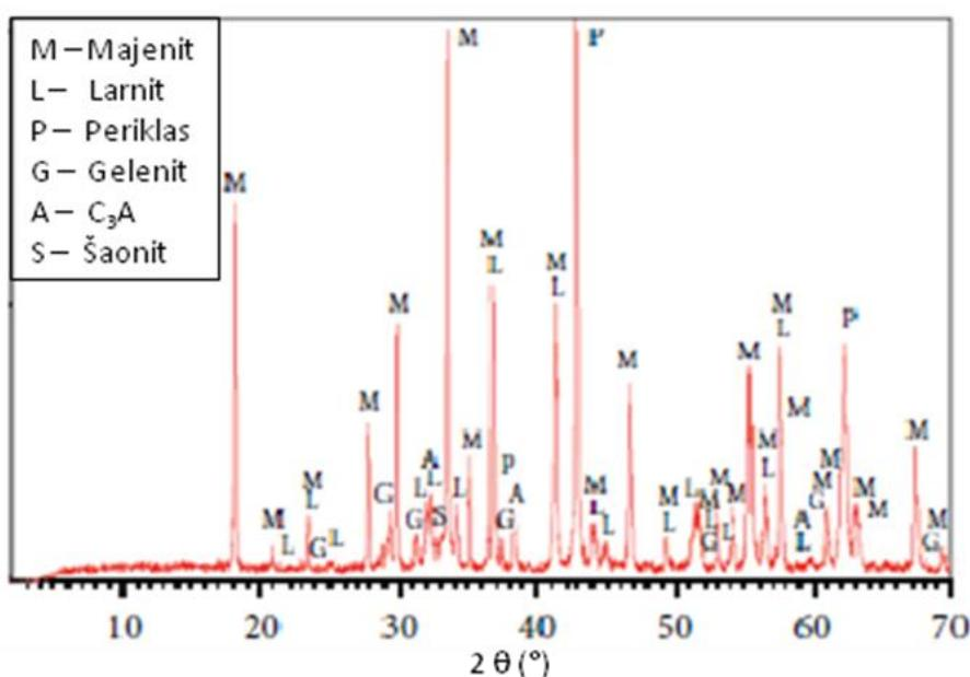
Slika 11. Difraktogram bijele troske iz lonac-peći [20]
