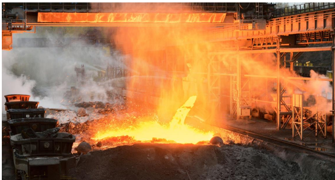
Slika 9. Hlađenje troske potpomognuto vodenim topovima [17]
