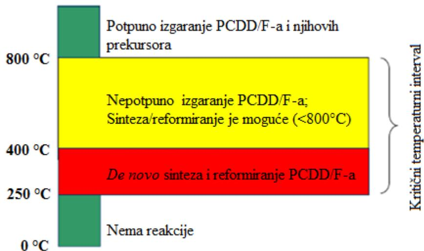
Slika 13. Princip termičke razgradnje PCDD/F-a u otpadnim plinovima ELP [34]
