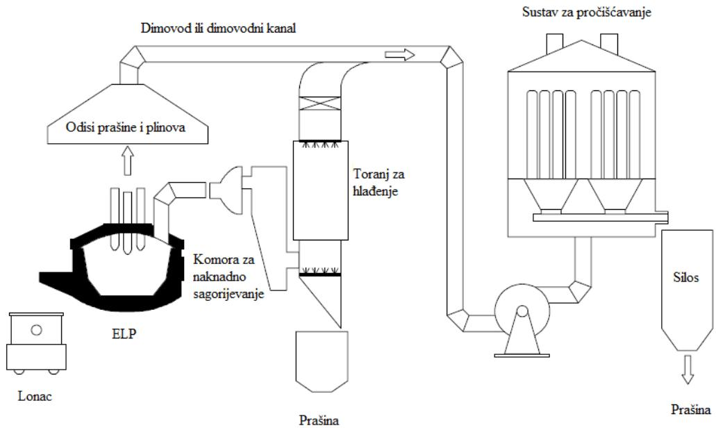
Slika 12. Shematski prikaz elektropećnog postupka opremljenog komorom za naknadno spaljivanje otpadnih plinova i tornjem za hlađenje vodom [25]
