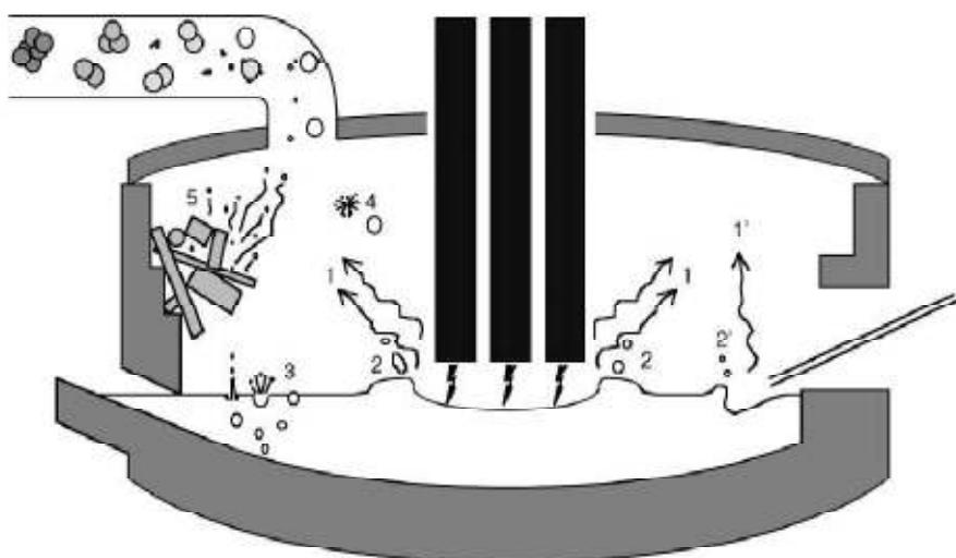
Slika 10. Shematski prikaz mehanizama nastajanja prašine u elektrolučnoj peći [26]
